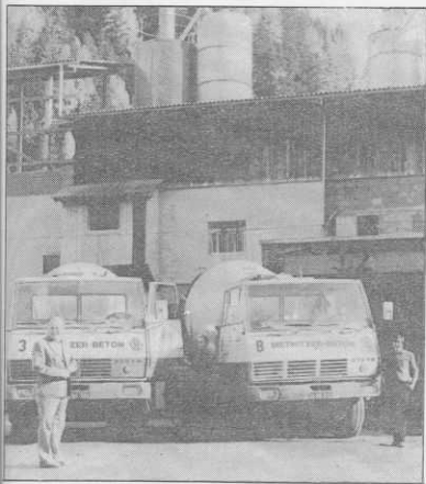
Zwei der „gelb-grünen Bomber“ vor dem Werksgebäude. Jeder dieser Mischwagen faßt 6 m 3 Beton.
